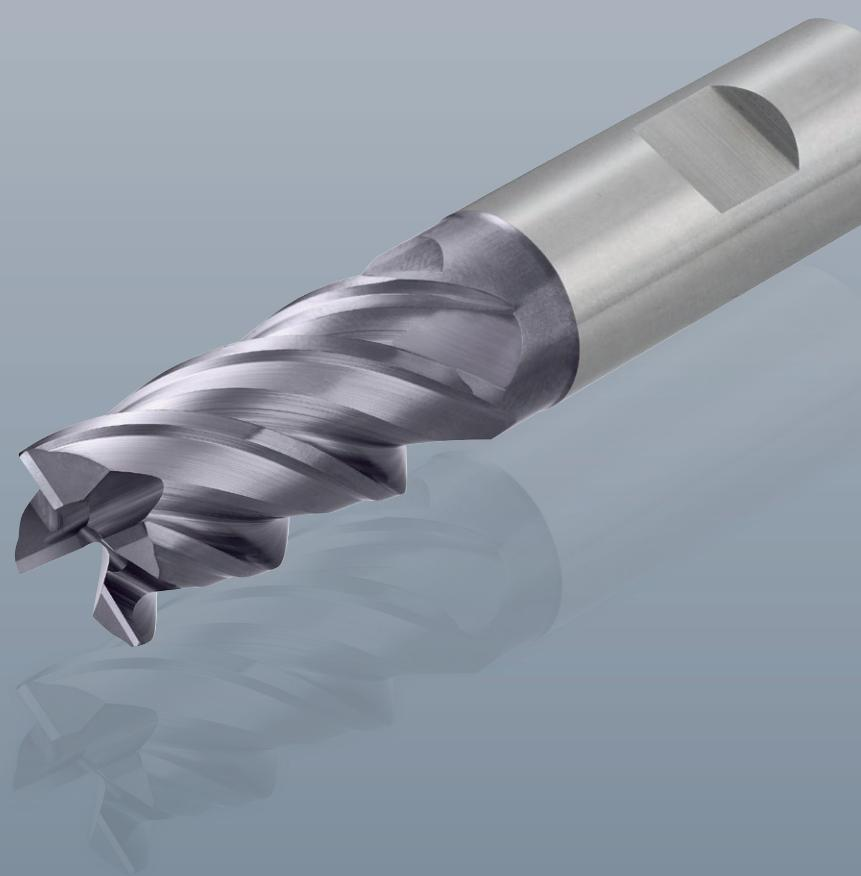
Nach dem DHC Premium wurde auch der DHC INOX von LMT Fette komplett überarbeitet und steht nun ebenfalls in der Premium-Version zur Verfügung. Der 4-schneidige Fräser wurde ursprünglich speziell für die Zerspanung von rost- und säure-beständigen Stählen, Titan- und Nickelbasislegierungen sowie kurzspanendem Aluminium entwickelt.
